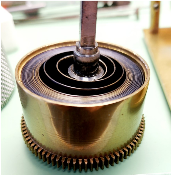
Abb: Die Zugfeder ist deformiert und könnte den Deckel abdrücken.
