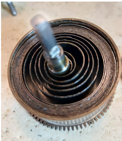
Abb: Die vielen Ringe zeigen die defekte Zugfeder.
