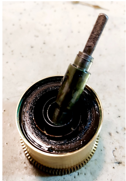
Abb: Die vielen Ringe zeigen die defekte Zugfeder.
